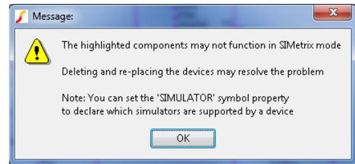
図 13. 不適切なモデルが混在している場合のエラーメッセージ
