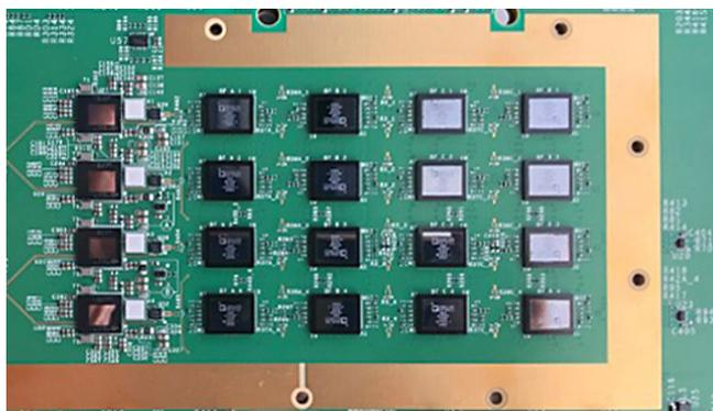
図2. AiB256の外観。アクティブ・コンポーネント側の面を示しています。16個のビームフォーマICと4個のアップ/ダウンコンバータICを使用しています。
