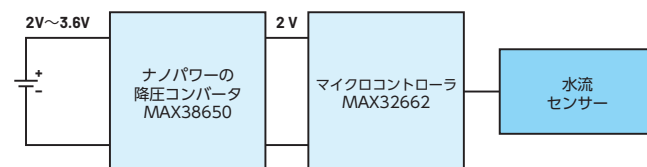
図2. ナノパワーのDC/DCコンバータを追加した回路
