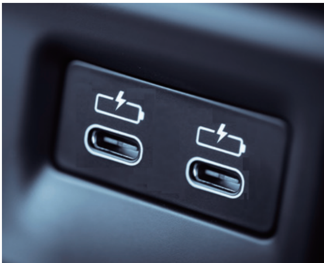
図8. 最新の自動車のデュアルUSB-Cポート
