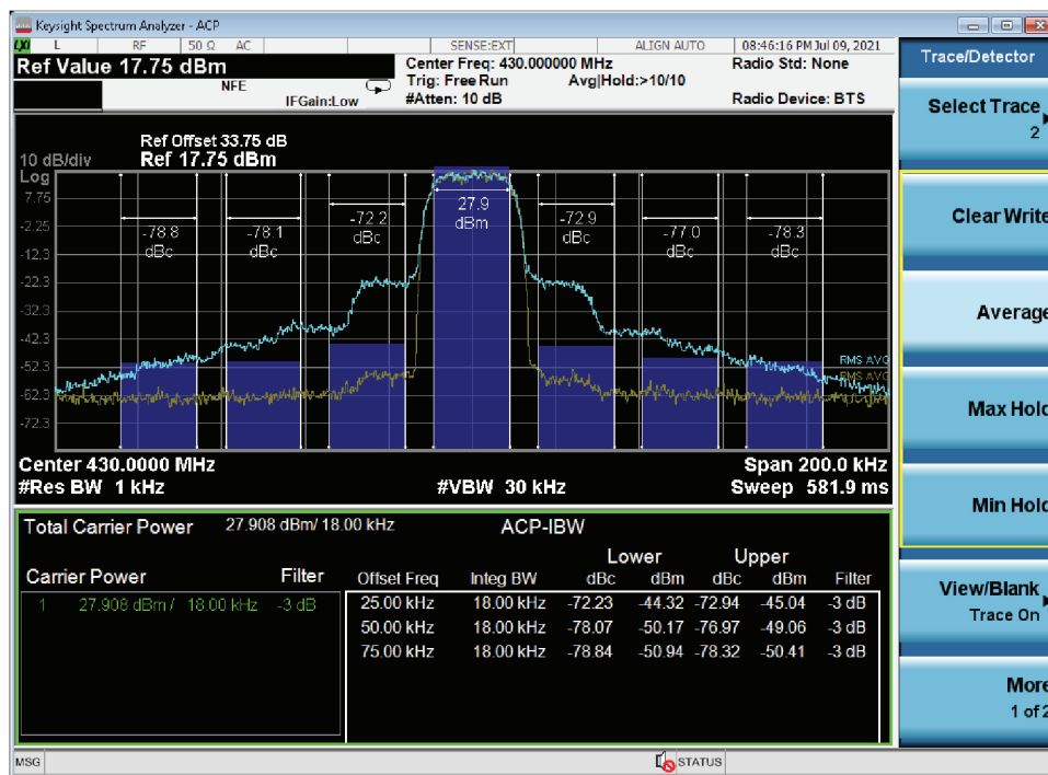
図1. DPDの効果。ADRV9002において、DPDを適用した場合と適用しない場合の結果を示しています。この評価はTETRA 1の条件を適用して実施しました。
