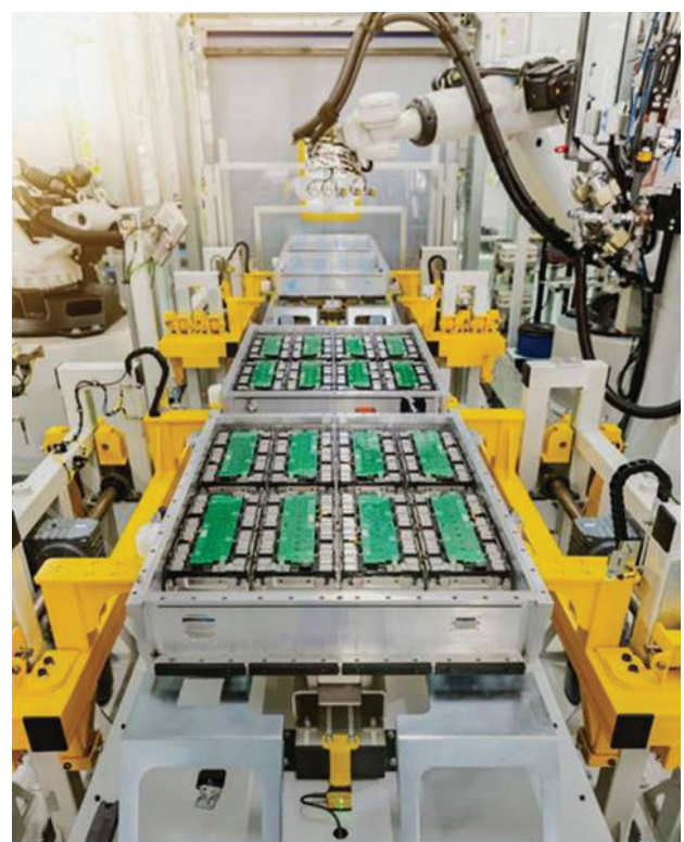
図2 wBMS技術は信号用ワイヤ・ハーネスをなくして、バッテリー・パックのロボットによる完全自動生産を可能にします。
