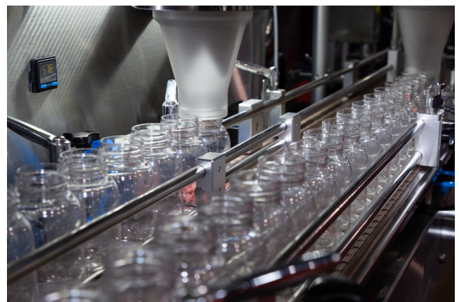
図9. ビン詰め工程の監視。ビン詰めの実施時や包装の完了後の監視作業には、大型のビジョン・システムがよく使用されます。そのようなシステムの設置が現実的ではない場合、LIDARを適用することで、ビン詰めを実施する前に損傷や欠陥を検出することが可能になります。このような仕組みは、特に、ビンの区別を視覚的に行うのが困難な場合に役立ちます。
