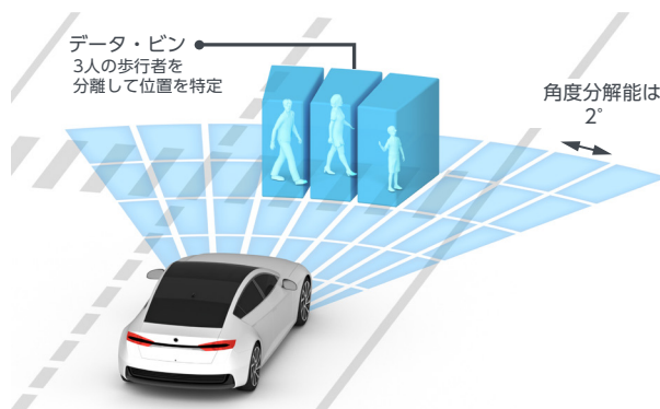
図 2. 分解能が高いイメージング・レーダーを使用した場合の例。 3 人の歩行者を分離して、それぞれの位置を特定することができます。
