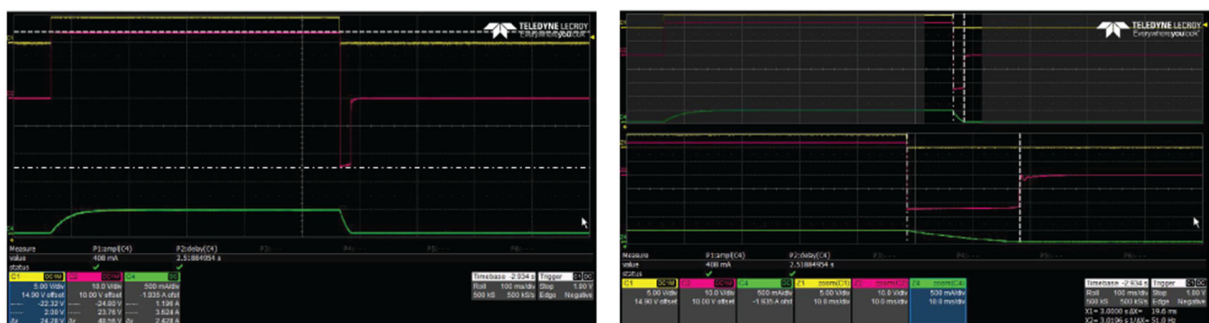
図 12. VNI8200 の高速消磁 (A - V_{CLAMP} 、B - t_{DEMAG} )
