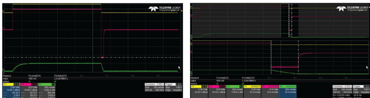
図 10. MAX14912 の高速消磁 (A - V_{CLAMP} 、B - t_{DEMAG} )
