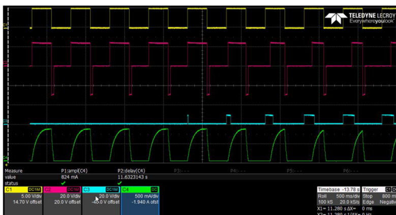
図 14 (a) . ITS4880R のテスト結果 (その 1)。8 つのチャンネルですべて同時に誘導性負荷をスイッチングしています。動作を開始して数秒後の結果です。
