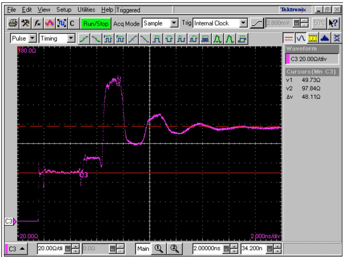
図7. DATA1 PCBのインピーダンスをTDRで測定した結果です。
