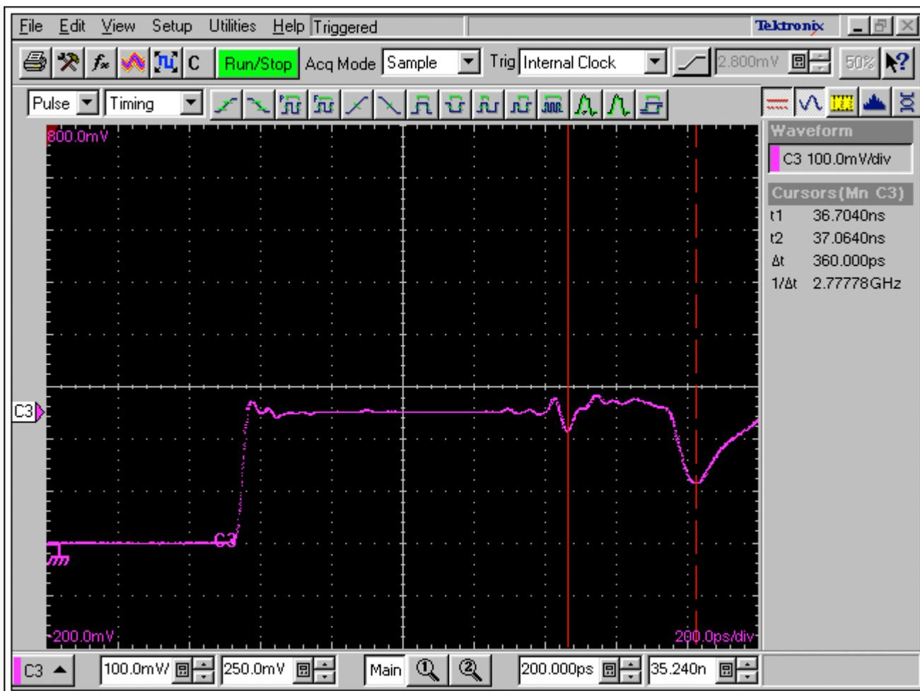
図9. DUT1 PCBの遅延とインピーダンスをTDRで測定します。
