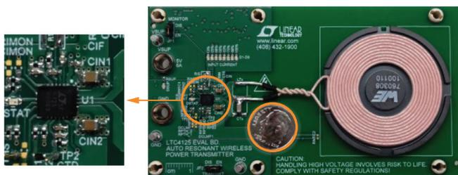
図6. LTC4125を使用した代表的なフル機能ワイヤレス・パワー・トランスミッタ・ボード
