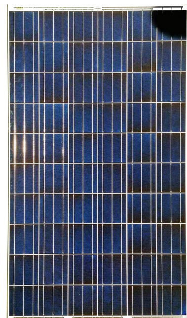
図3. 右上隅が日陰になっている太陽電池パネル
