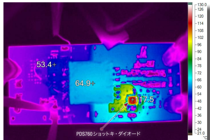
図3. ダイオードPDS760を使用した5V/5A出力での熱画像
