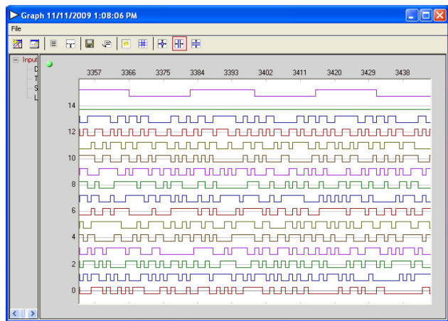
図9. ビット14が欠落したAD9268 ADC。
