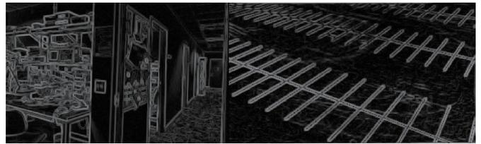
図 9. エッジ・ノードで使用する、DSP 対象物検出アルゴリズムを用いた高ダイナミック・レンジのイメージャは、低照度条件でも動きや境界への侵入を判断できます。この例では、屋内の工場/オフィス（左）と屋外の駐車場（右）のエッジ検出を定義するのに視覚的なコントラストを使用しています。
