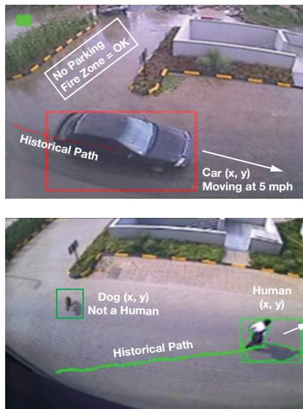
図 8. エッジ・ノードでビデオ解析を用いると、対象物の種類の検出、軌跡、および境界の交差は、ビデオ・データの全帯域幅をクラウドに送信して解析しなくても、低電力システムで判断することができます。ブレッドクラム・オブジェクトの座標と種類を含むタイムスタンプを送信するだけで済みます。
