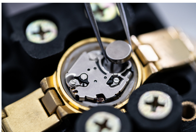
図3. 酸化銀電池の外観。 腕時計用の電池として一般的に使用されています。
