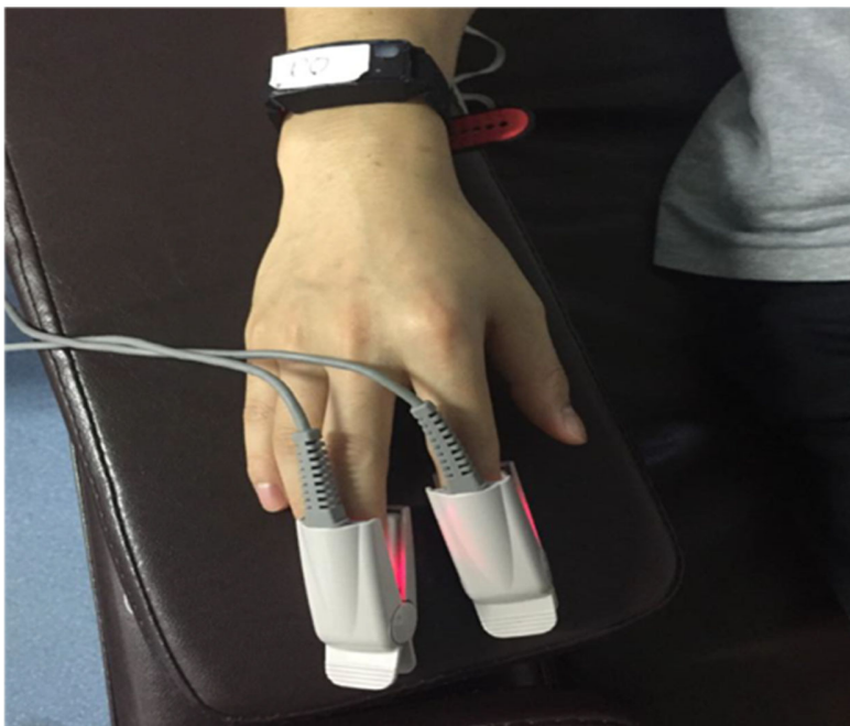
図 7. 被験者の手元の様子。腕時計型の機器にはアナログ・デバイセズのセンサーが実装されています。人差し指と中指には 2 つのリファレンス機器の指クリップを装着しています。
