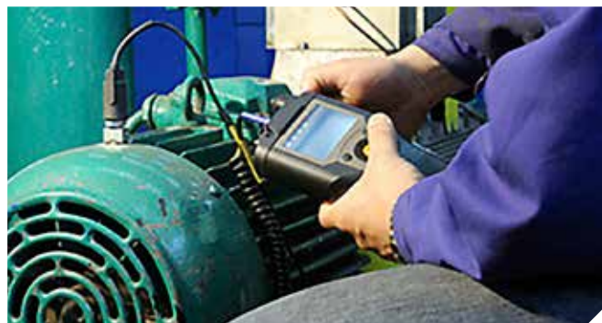
図 2. 再現性および信頼性の低い現在の手法による機器の振動監視。
