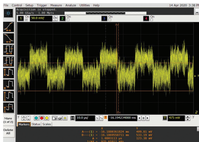
図8. -75dBmの連続パルス信号を入力した場合の出力応答
