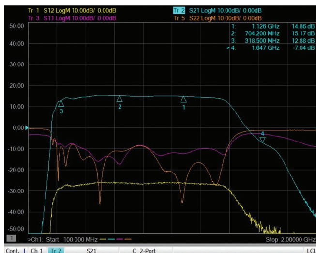
図6. フィルタを適用しないで最終段まで到達した場合のSパラメータ
