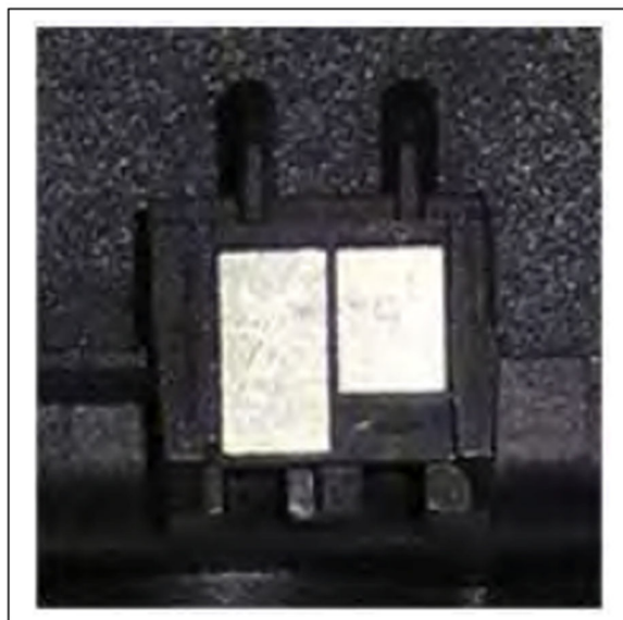
図 4. 最終製品にクリップで取り付けられた 1-Wire Contact Package
