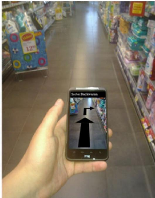
図10. 加速度センサーで実現した屋内ナビゲーション機能
