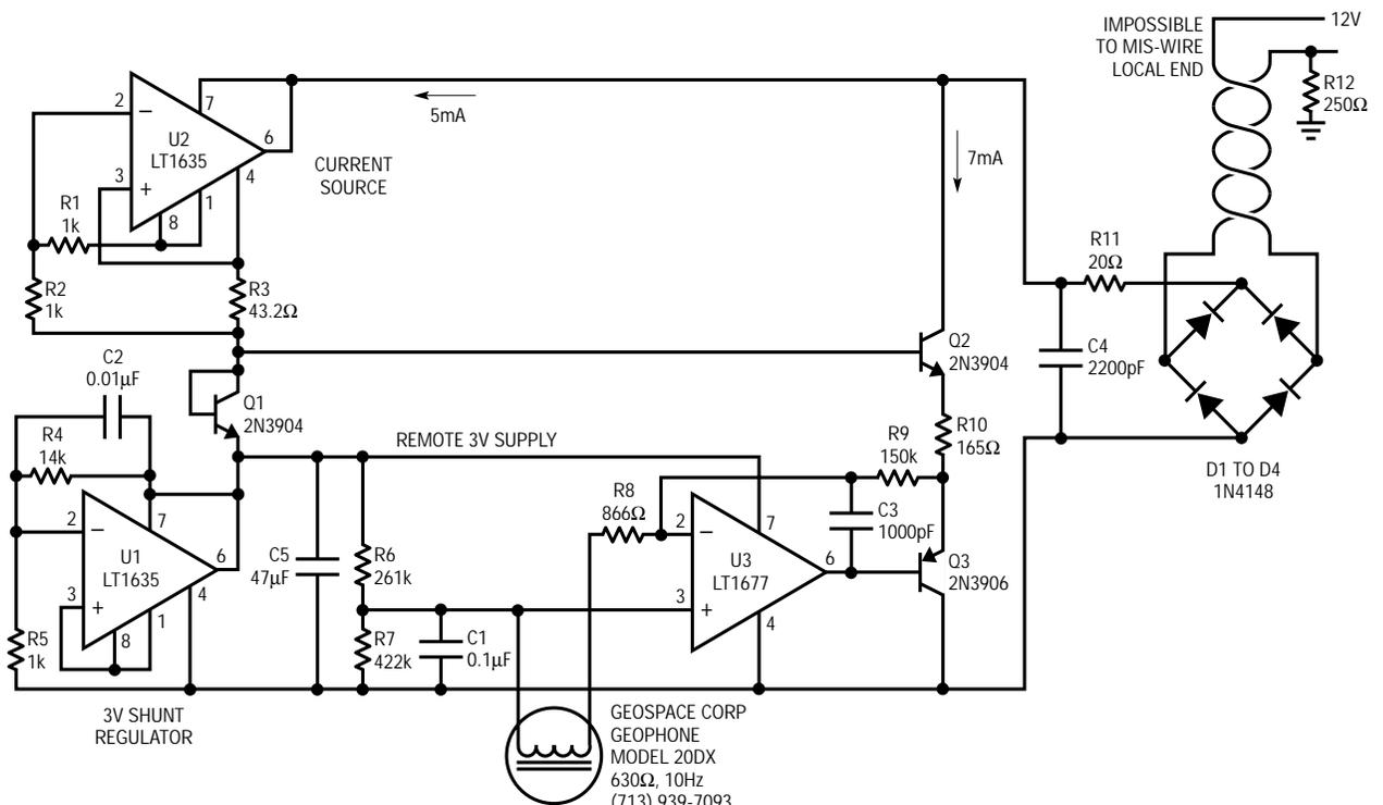
図1. リモート2線式Geophoneプリアンプ
