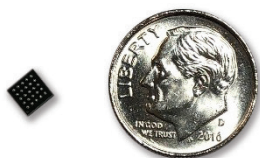
図1. LTM8074はSilent Switcherアーキテクチャの採用により、小型パッケージに全機能を内蔵した低ノイズ・ソリューションを実現。
