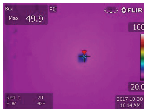
図2. 室温 (23°C)、全負荷 (12V入力、5V出力 (1A)) の条件で、LTM8074の温度上昇はわずかです。
