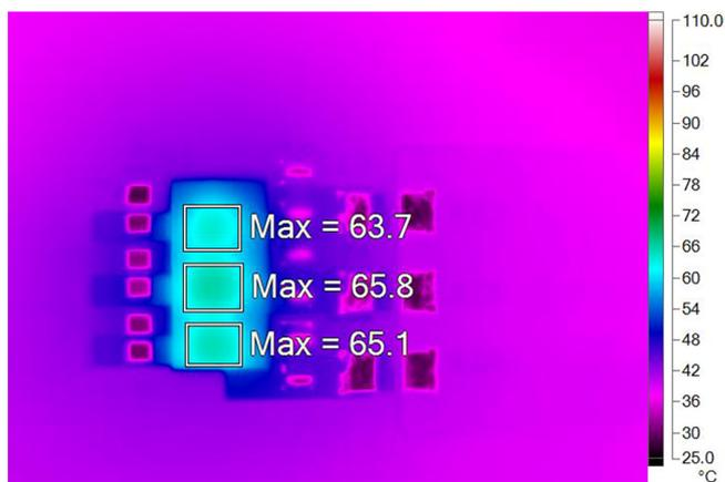
図5. 熱画像:全負荷、3つのチャンネルを並列化(1.3V $_{IN}$ 、1V $_{OUT}$ 、9A)、ファンなし、 $T_A = 25^\circ\text{C}$
