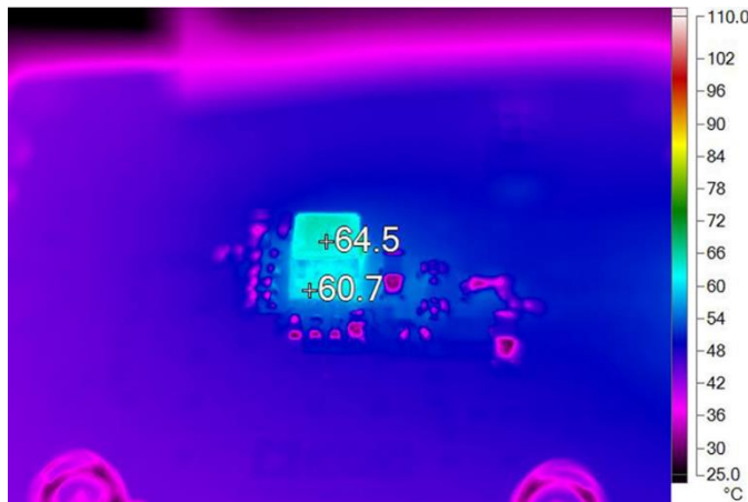
図5. 空気流なし、ヒート・シンクなしの場合の12VIN、1V/8A出力時の熱画像
