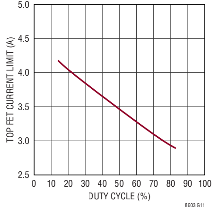
チャンネル2のピーク電流制限と デューティ・サイクル
