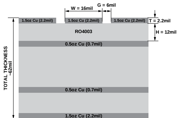
図 27. 評価用ボードの層構成の断面図
