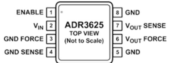
図1.8ピンMSOPのピン配置
