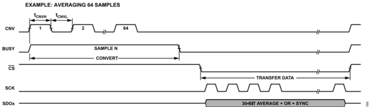
図 56. 平均化モードの変換サイクル例
