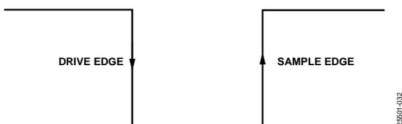
図 34. SPIモード3のSCLKのエッジ
