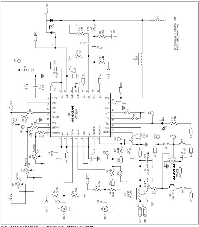
図3. MAX3669EVキットの回路図(光学的評価用構成)
