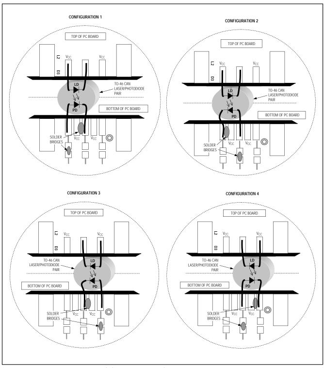
図1. MAX3669EVキットへのレーザダイオード/モニタダイオードの装着
