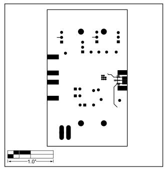
図9. MAX3669EVキットの部品配置図(ハンダ面側)
