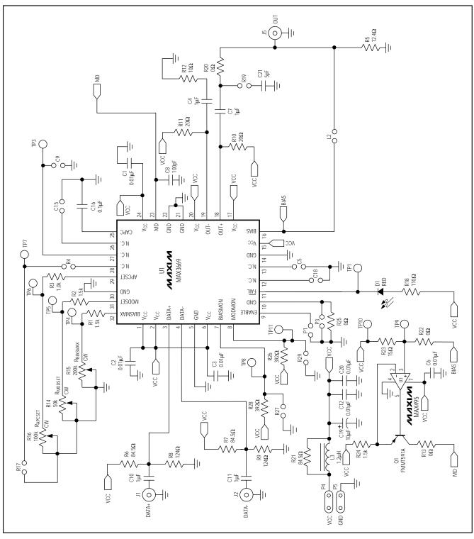
図2. MAX3669EVキットの回路図(電気的評価用構成)
