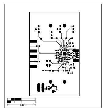
図5. MAX3669EVキットのプリント基板レイアウト (部品面側)
