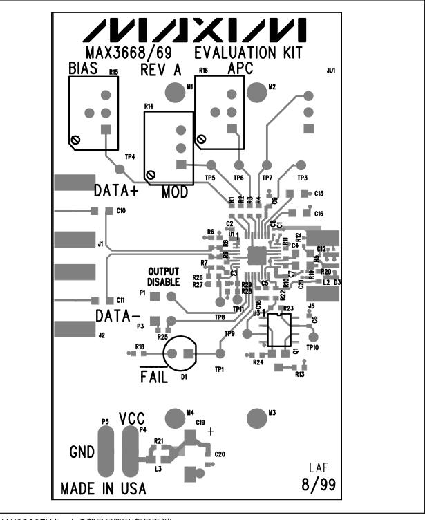
図4a. MAX3669EVキットの部品配置図(部品面側)
