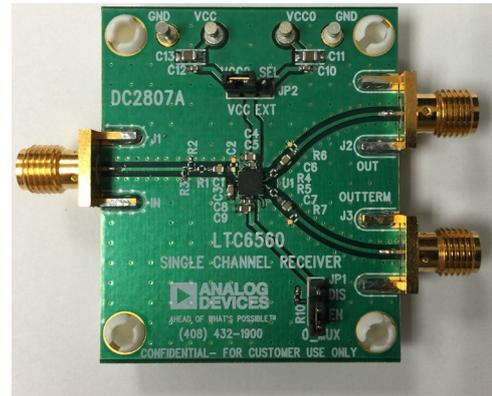
図11. DC2807Aシングル・チャンネル電気的評価用ボード
