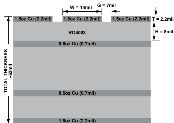
図 23. 評価用ボードの断面図
