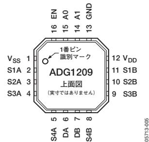
図6. ADG1209のピン配置 (LFCSP\_VQ)、
