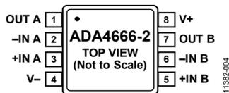
図 4.8 ピン MSOP のピン配置
