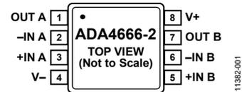
図 1.8 ピン MSOP
