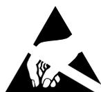
ESD（静電放電）の影響を受けやすいデバイスです。電荷を帯びたデバイスや回路ボードは、検知されないまま放電することがあります。本製品は当社独自の特許技術である ESD 保護回路を内蔵していますが、デバイスが高エネルギーの静電放電を被った場合、損傷を生じる可能性があります。したがって、性能劣化や機能低下を防止するため、ESD に対する適切な予防措置を講じることをお勧めします。
