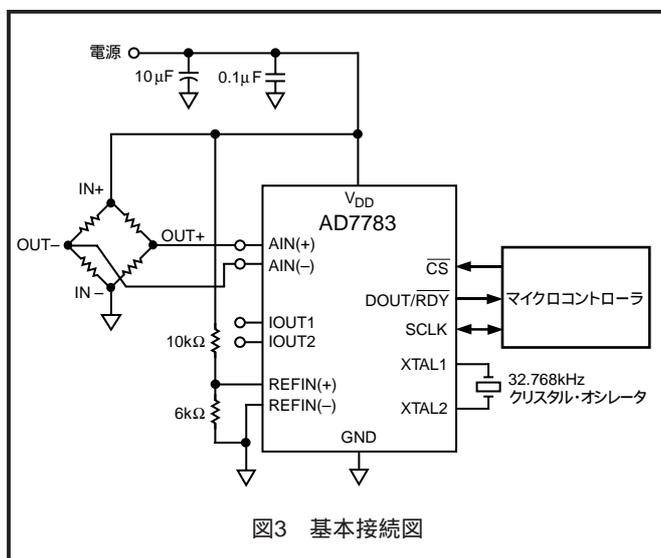
AD7783 ( $f_{ADC}$ ) の出力レートは次式で表されます。
