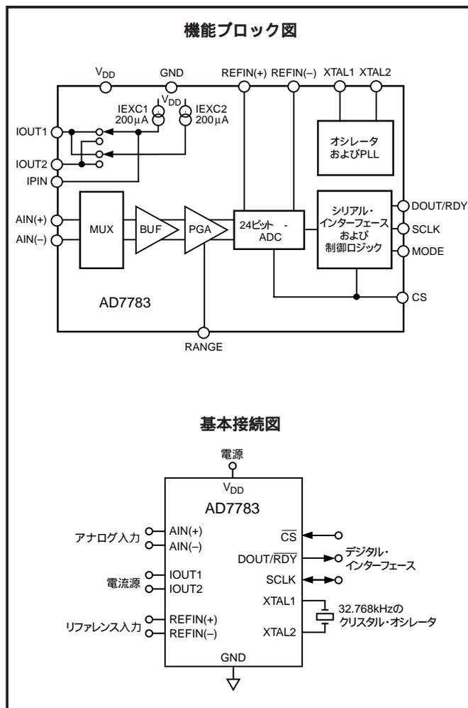
AD7783は、内部で使う各動作周波数を発生させる内蔵PLLと、32.768kHzクリスタル・オシレータからの発振を使って動作します。デバイスの出力データ・レートは固定であり、マスター・クロック19.79Hzを使っています。この更新レートで50Hzおよび60Hzの同時除去を行います。18ビットのピークtoピーク分解能がこの更新レートで得られます。
