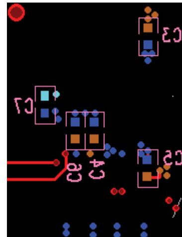
図 86. 最下層のデカップリング
