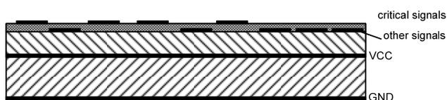
図22.不適切: VCC プレーンと GND プレーンとの間隔が大きすぎる例
