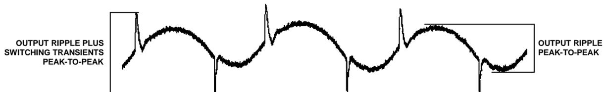
図 1. 出力リップルとスイッチング・トランジェント
