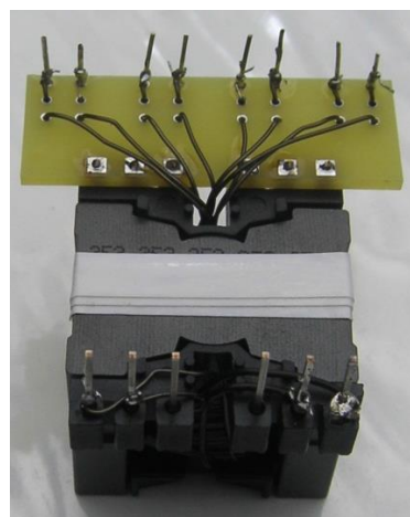
図 17. ボビン・エクステンダによるプロトタイプ・フライバック・トランス
