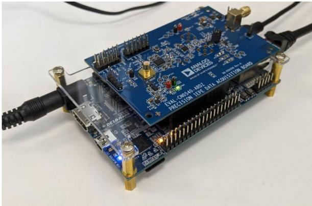
図 18. Terasic DE10-Nano Carrier Board にマウントされた EVAL-CN0540-ARDZ
