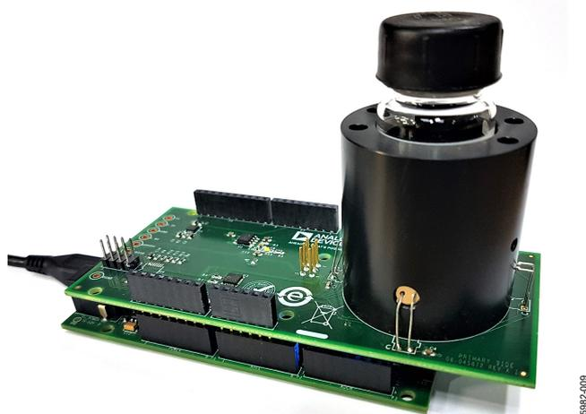
図 9. EVAL-CN0409-ARDZ および EVAL-ADICUP360 を使用した水濁度測定の実験・テスト
