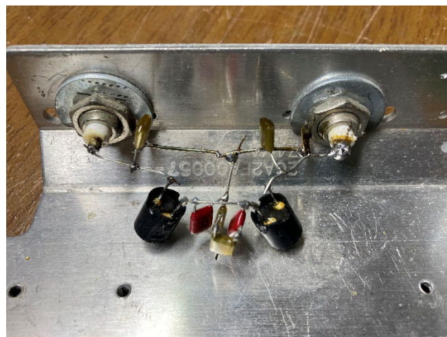
図 12. 図 11 の 5 次 LC LPF を実際に作ってみた（入出力インピーダンス 600\Omega 。アマチュア・チックですいません。それでも一応相互インダクタンス結合を避けるために、黒の 470uH のインダクタは 90^\circ 弱相互に傾けてあります）
