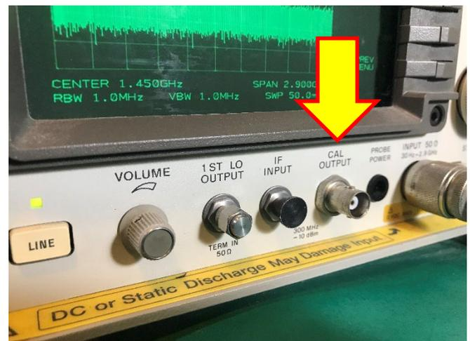
図 7. 8560E の 300MHz CAL OUTPUT 出力
