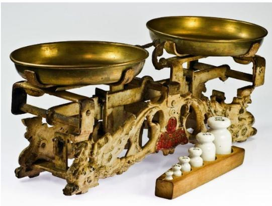
図11. CORDIC の演算手順は天秤と分銅による重量計測と同じ (Old two pan balance, Nikodem Nijaki, Jan. 29 2011, Wikimedia Commons, [https://commons.wikimedia.org/wiki/File:Balance\\_scale\\_IMGP9728.jpg?uselang=ja](https://commons.wikimedia.org/wiki/File:Balance_scale_IMGP9728.jpg?uselang=ja))
