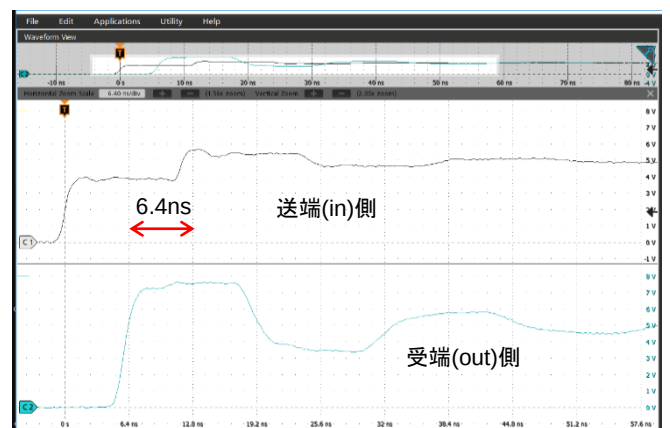
図 16. 高速な VHCMOS で実験した結果〔上側が信号源側（送端）、下側が負荷抵抗側（受端）〕
