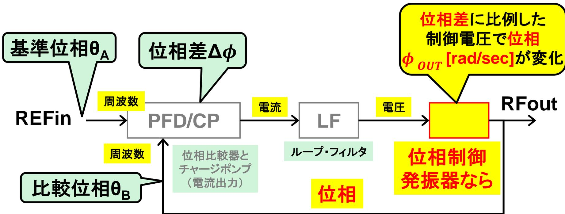
位相を制御するフィードバックで「比例」として考えるなら、位相差に比例した制御電圧で位相がリニアに変化することが正しいだろう
