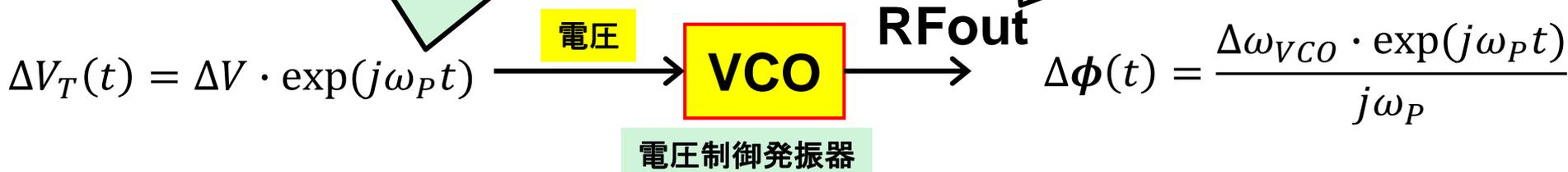
VCO制御感度 $K_V$ [rad/s/V] $\Rightarrow \Delta V$ と $\Delta\omega_{VCO}$ の関係が $K_V = \Delta\omega_{VCO} / \Delta V$ なので
