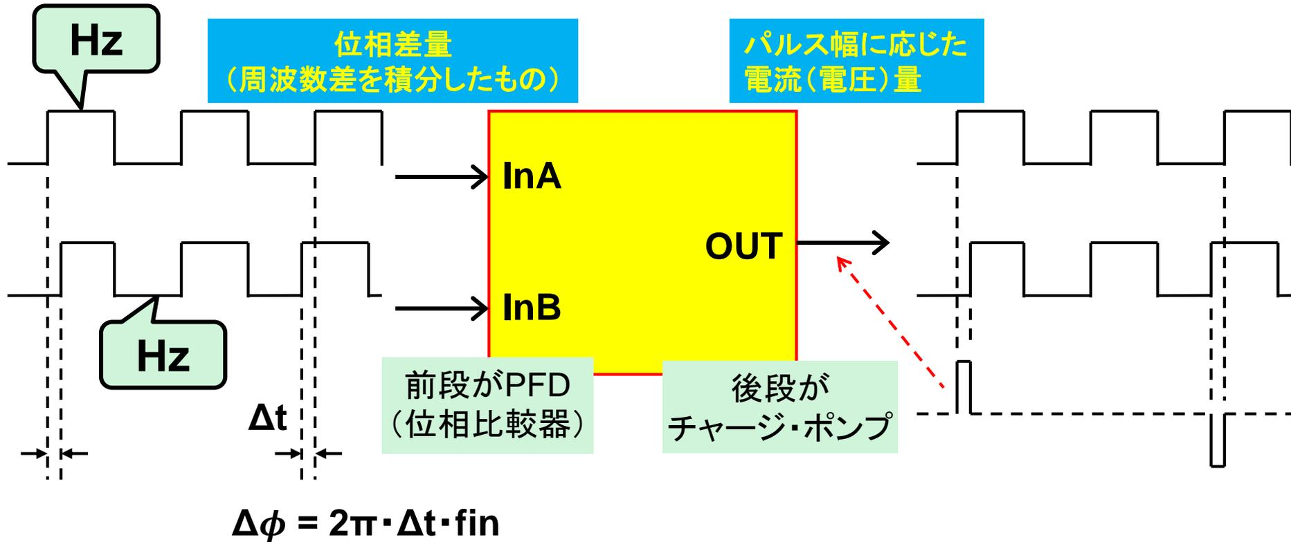
PFDの位相差 $\Delta\phi$ に比例した電流(または電圧)を出力（ADI製品は電流出力）
