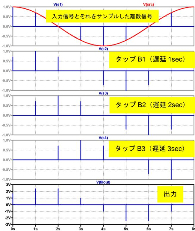
図 12. 同一構成の遅延形平均化フィルタに離散時間信号を入力してもデジタル・フィルタとして成立する
