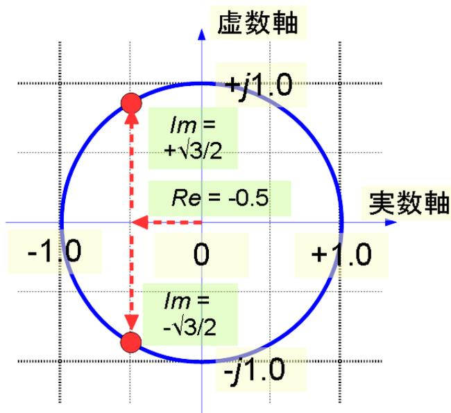
図7. 極の位置を複素数平面上（実際はラプラス平面上）に表してみる。 $\omega_0 = 1$ としている
