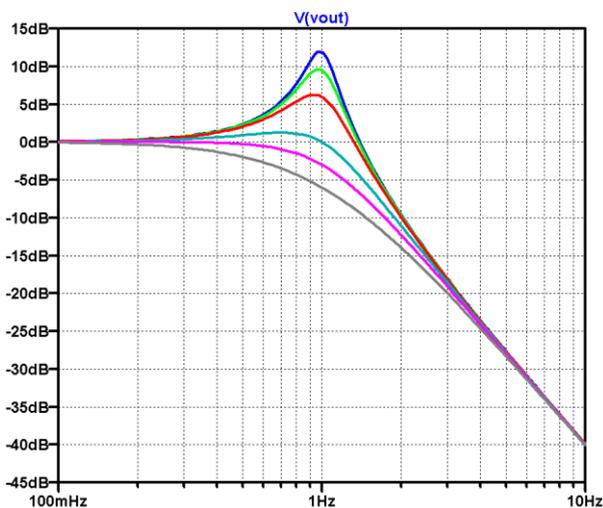
図 5. 図 4 の回路の Q 値ごとによる振幅伝達特性
