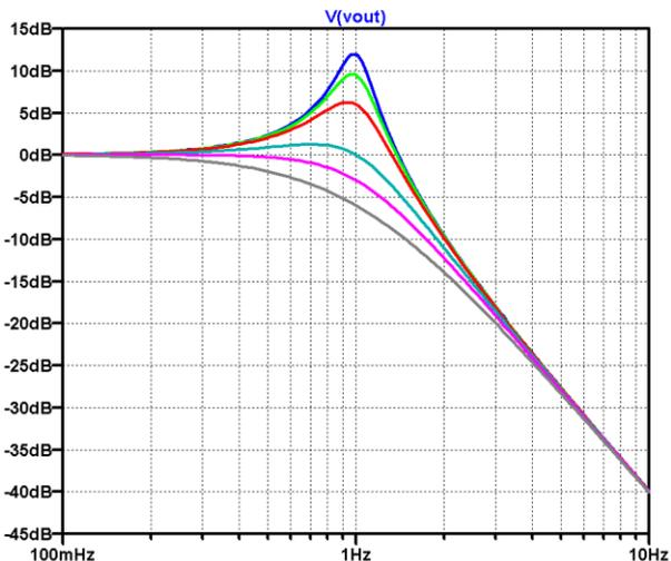
図 3. 図 2 の回路の Q 値ごとによる入出力振幅伝達特性
